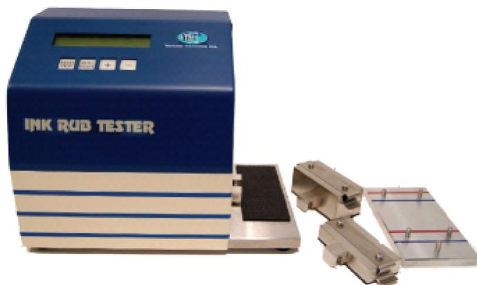
油墨摩擦仪用来评价油墨与印刷表面结合的牢固程度。可进行干摩擦（油墨从干燥表面转移到另一干燥表面）、湿摩擦（油墨从湿表面转移到另一湿表面）等油墨摩擦转移实验。另外，配置加热重物，可以测试包装盒、标签纸等的热油墨摩擦转移。
